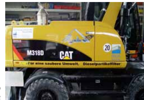
Zeppelin Mobilbagger CAT M318D mit PHYSITRON SiC-CTB
